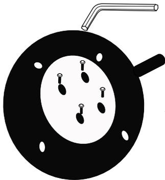
PASO 2: Poner el mecanismo en el plato de nylon y poner tornillos por la parte de abajo o de atras.
