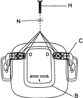
**3** Coloque el mecanismo al asiento los tornillos 6x30mm (4 pz)
