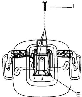
**4** Coloque el respaldo al asiento y al mecanismo y coloque las rondanas y arillos los tornillos 8x20 mm (3 pz)
