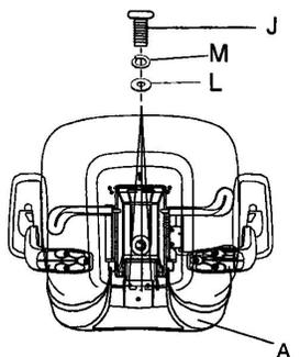
Ensambla el asiento y respaldo previamente armado a la base y pistón.
