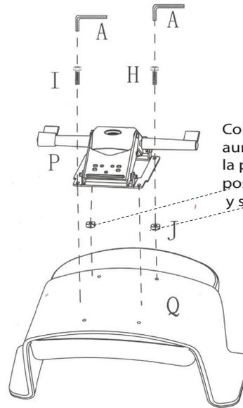
Coloque primero los aumentos plasticos en la parte trasera del asiento posteriormente se coloca el mecanismo y se atornilla con los tornillos delgados
